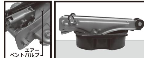
③<オイルの補充>の手順②～④に従って新しい油圧用オイルを注入し、カバーブレートをピンで取付けて下さい。
