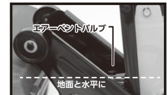
②エアーベントバルブを市販のプラスドライバー(3番)で反時計回りに回し外し、オイルレベルを確認して下さい。
