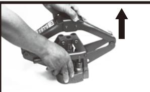
②ジャッキ本体の上部を掴み、約1/2ストローク(130mm程度)まで引き上げて下さい。
