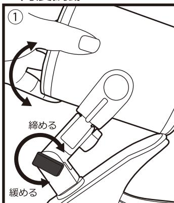
①風向きを上下に変えたい場合は、モーター部をしっかりと支えた状態で支柱下部のレバーをゆるめ、上下に動かし、角度を調節して下さい。
