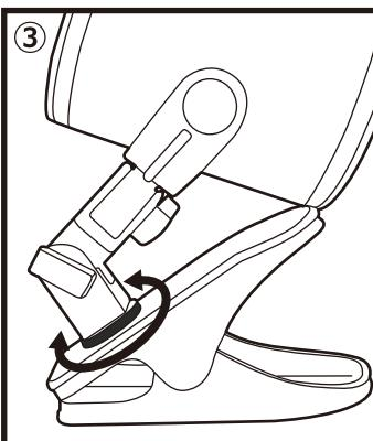
③支柱回転軸を回して、ルーバーの向き(吹出し口)を調節できます。
