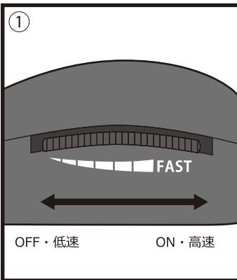
①電源・風量調節スイッチで、高速側(FAST)にダイアルを回すと電源が入ります。電源を切る場合は、低速側にダイアルを戻して下さい。
