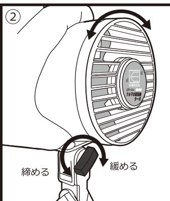
②風向きを左右に変えたい場合は、モーター部をしっかりと支えた状態で支柱上部のレバーをゆるめ、左右に動かし、角度を調節して下さい。
