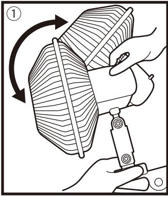
①風向きを上下に変えたい場合は、支柱の付け根部をしっかりと支えた状態でモーター部を上下に動かし、角度を調節して下さい。
