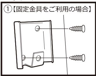
②付属の固定金具と固定金具用ビスAを使ってお車の壁面に取付けて下さい。
