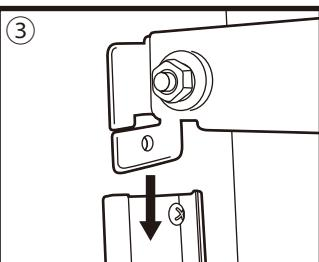
④壁面に取付けた固定金具にビスを外した本体を差込む。
